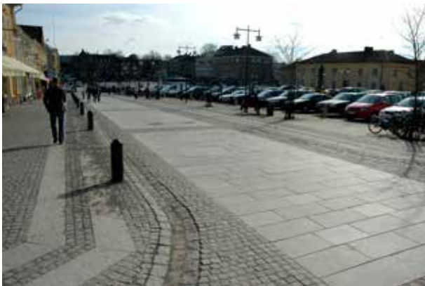
Fig 4.25 Gårdsgata med beläggning av granithällar och smågatsten
